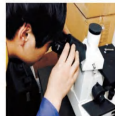
1000倍金相显微镜 GX41F Metaloscope
