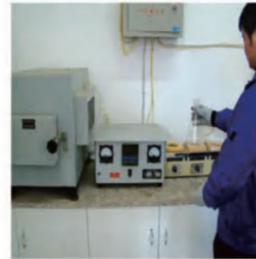
晶间腐蚀corrosion test
